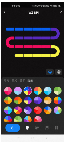
组合： 选择按比例分配的多色圆盘， 将颜色均匀地分布在LED灯带上。
