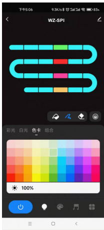
色卡： 触摸色卡盘选择多种不同颜色。 触摸亮度条调节亮度。
