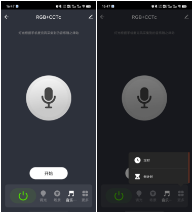
音乐播放可以使用智能手机音乐播放器 或麦克风作为音乐信号输入。 倒计时可以设置在将来24小时内自动开启或关闭灯光。 定时键可以添加多个定时器，根据不同的时间来开启 或关闭灯光。
