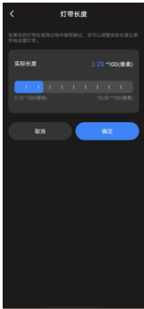
灯带长度界面 根据灯带的实际长度选择 合适的像素点数，最小10，最大1000。
