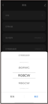
灯带颜色顺序界面 根据灯带的颜色顺序选择 对应的R/G/B/W/C顺序 (见表1)。
