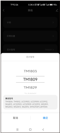
芯片型号选择界面 根据灯带的芯片类型选择对应的型号。
